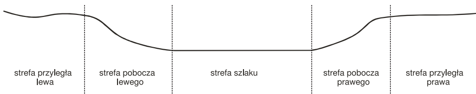
Ryc. 1. Schemat profilu poprzecznego szlaku
